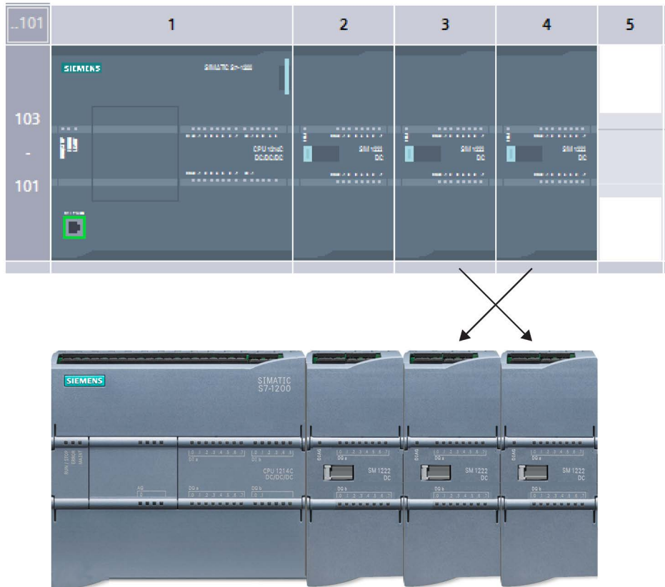
Figura 6-3 Configurazione del dispositivo rispetto all'installazione reale con scambio dei moduli nei posti connettore 3 e 4
