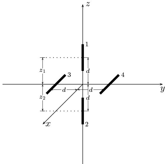
Indichiamo con  $z_1$  la quota sull'asse  $z$  del centro dell'antenna 1 rispetto all'origine del sistema di riferimento e con  $z_2$  la quota sull'asse  $z$  del centro dell'antenna 2 rispetto alla stessa origine.
