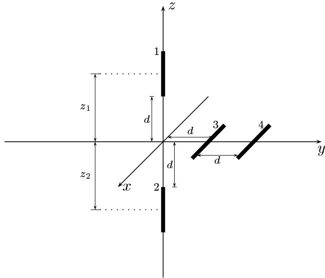
Indichiamo con  $z_1$  e con  $z_2$  le distanze dall'origine sull'asse  $z$  dei centri delle due antenne 1 e 2.
