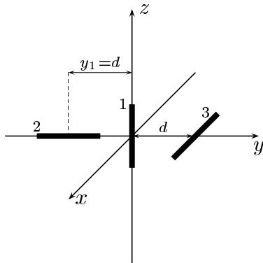
Indichiamo con  $y_1$  la distanza dall'origine sull'asse  $y$  del centro dell'antenna 2.
